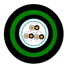
**Conductor:** 1.5mm2 Annealed copper wire conductors class 2.
